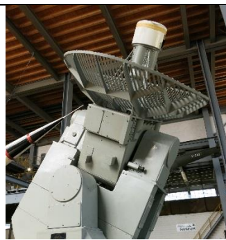
Typ C/D: Grobstrahl direkt nach vorne, Feinstrahl retour zum Spiegel. Drei Drehachsen. Kontinuierlicher Strahl, Rotation mit 100 Hz (2.7° resp. 20° breit).
