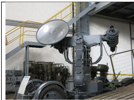
Typ A: Feinstrahl im Bild links, Grobstrahl rechts nur winzig, ein kleiner Strahler (faustgross) ist schräg auf die Drehachse montiert (es fehlt wohl der Wetterschutz).
