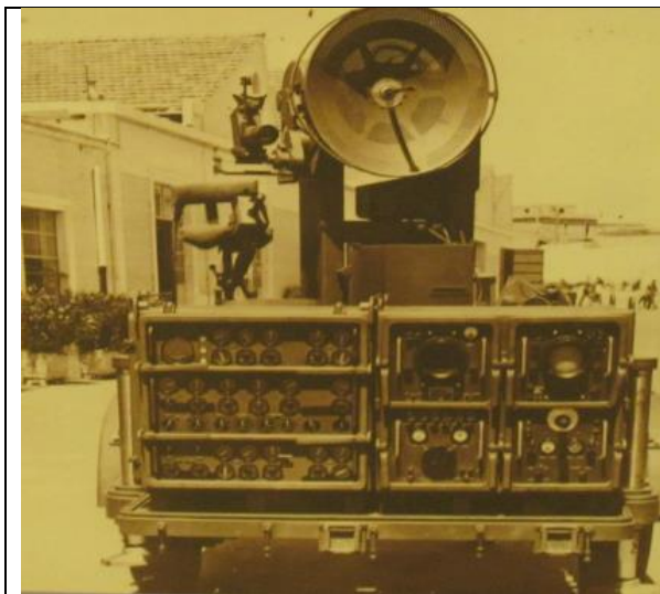
Falcon, Contraves Italiana, Roma. Leuchtschirme für Radar müssen im Betrieb abgedunkelt werden (in Ref. 1 ist Rechner um 90° gedreht auf Anhänger).
