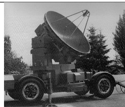
Typ E: Keine Strahl-Rotation, sondern eine Kommandolenkung, d.h. die fertigen Steuersignale werden am Boden ausgerechnet. Radar (Albiswerk) überwacht Ziel und steuert bis zu 3 Lenkwaffen.
